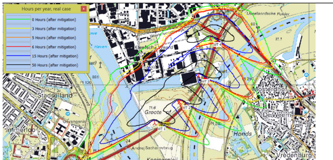
Figuur 5.6 Slagschaduw kan worden teruggebracht tot de norm van 6 uur/jaar bij een minimale mitigerende maatregel
