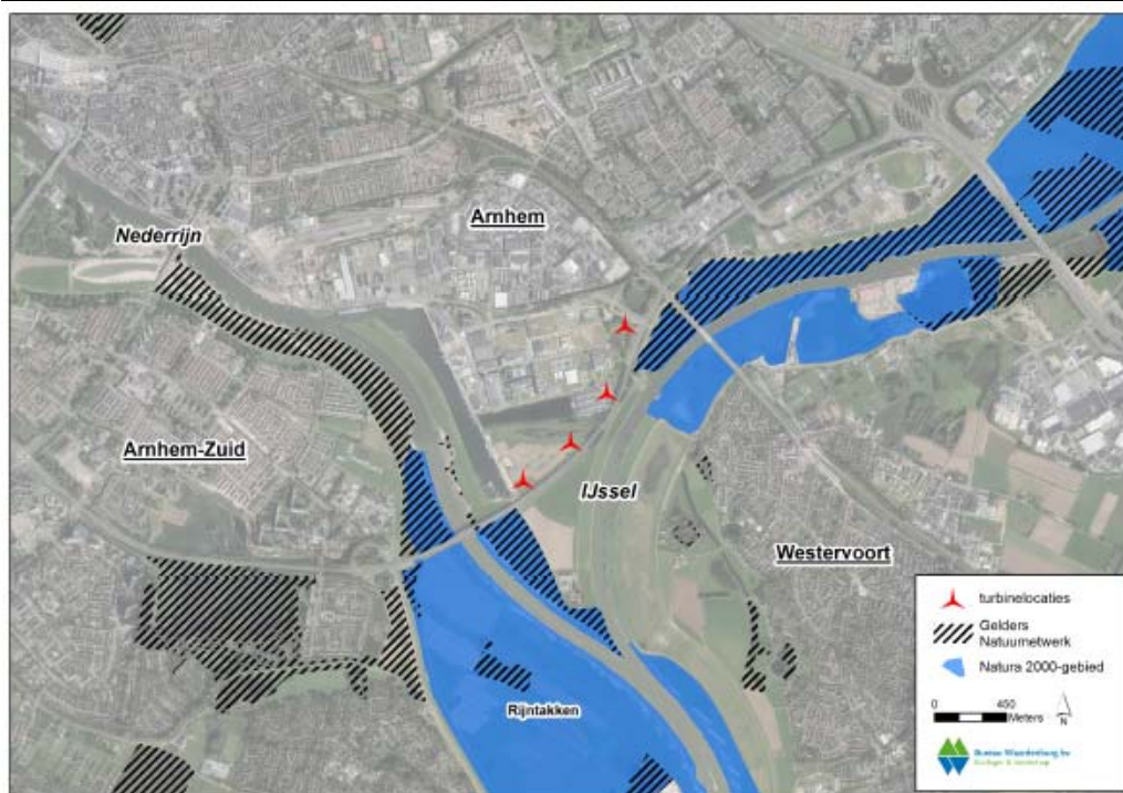
Figuur 2.5 Locatie van de vier windturbines en de ligging van Natura 2000-gebied Rijntak in de directe omgeving van het windpark
