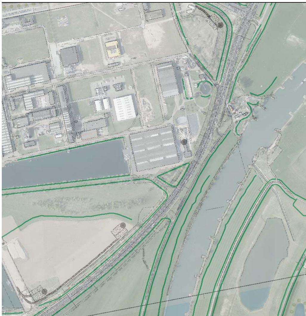
Figuur 2.4 globale situatieschets start talud (groene lijn) van primaire kering plangebied
