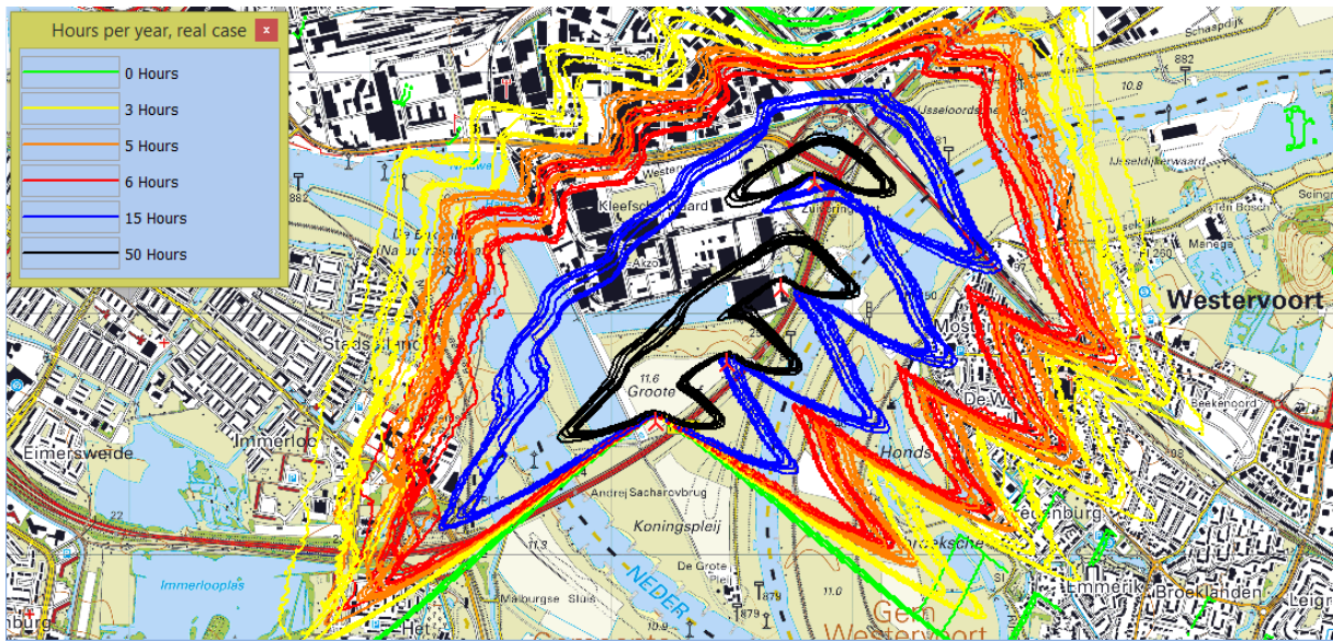
Figuur 4a: Vergelijking slagschaduwcontouren voor alle turbinetypen (uren per jaar)
