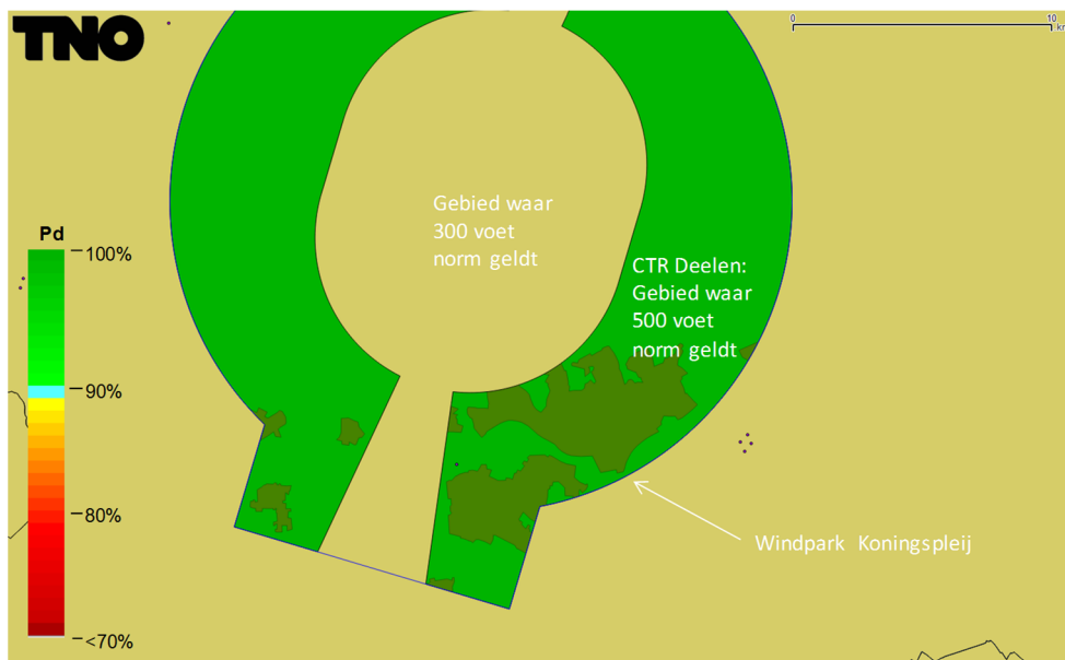
Figuur 8 Detectiekans van het MASS primaire verkeersleidingsradarnetwerk op 500 voet boven het bouwplan voordat dit is gerealiseerd (baseline).
